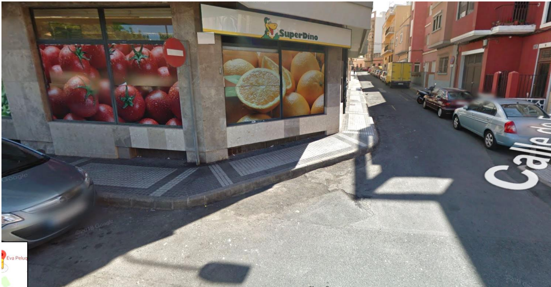
Imagen 1- Cruce C/Inesilla (Vía principal) con C/Fernando Calpena existencia de barrera arquitectónica y ausencia de paso peatonal
