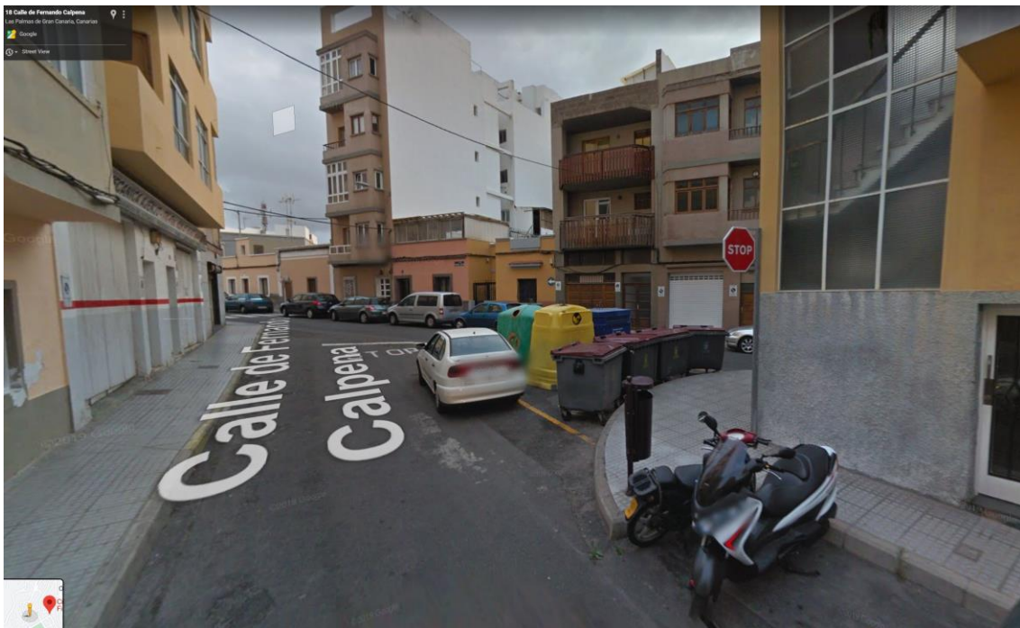
Imagen 9- Intersección calles de Fernando Calpena con Teodoro Golfín. Acceso limitado a contenedores verde, amarillo y azul. Riesgo por poca visibilidad del cruce por mal estacionamiento de vehículos. Solicitud ampliación acera, acondicionamiento zona y recolocación de contenedores en hilera.
