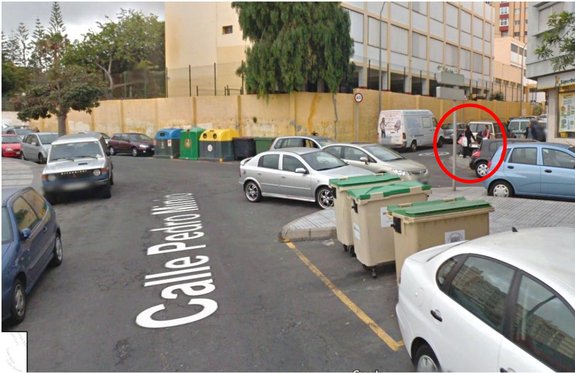
Imagen 5- Cruce C/Inesilla (Vía principal) con C/Pedro Minio con C/Sor Simona con existencia de barreras arquitectónicas y ausencia de paso peatonal. Estacionamiento de vehículos en cruce dejando poca visibilidad para peatones.
